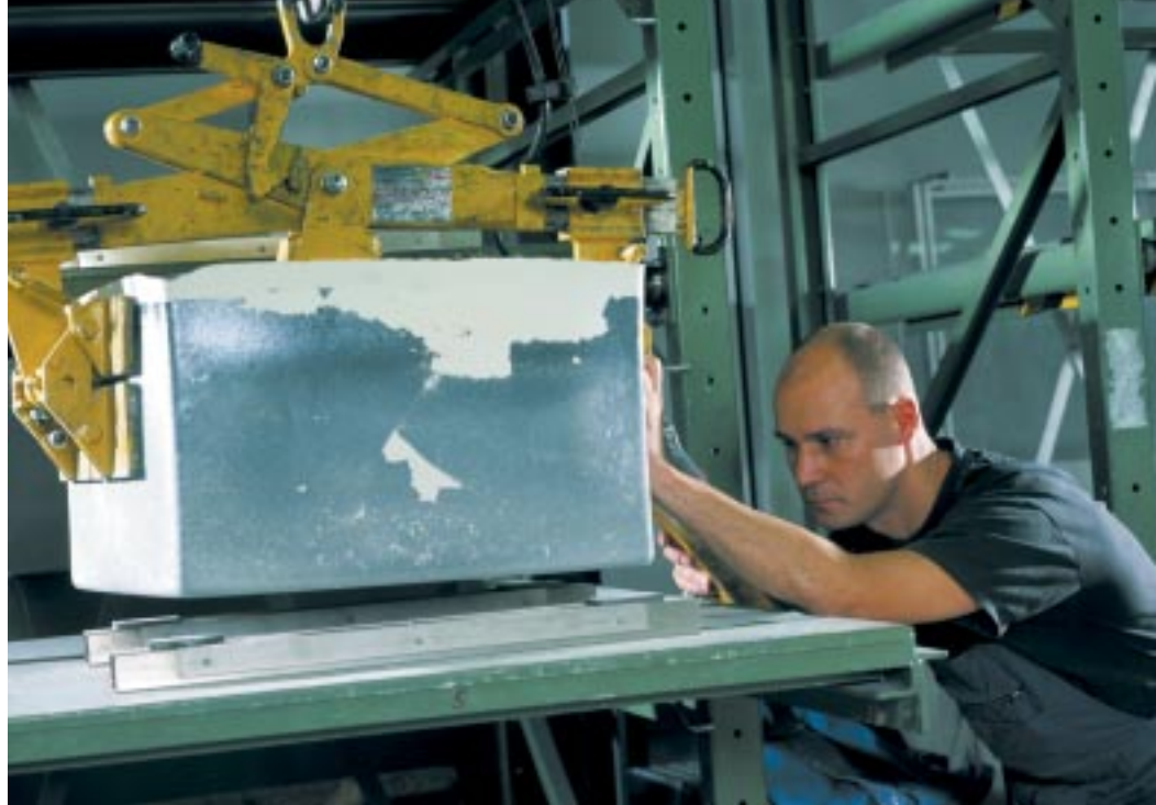
Abbildung 2: Herstellung multikristalliner Siliziumscheiben für Solarzellen. Das Bild zeigt den Blockguss als eines von drei Verfahren: multikristallines Silizium wird in Blöcken gegossen, die durch Drahtsagen in quadratische Scheiben geteilt werden.
