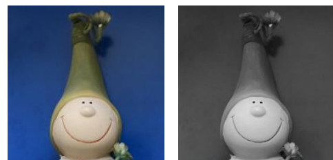
Abbildung 6: Umwandlung eines Farbbildes in ein Graustufenbild
