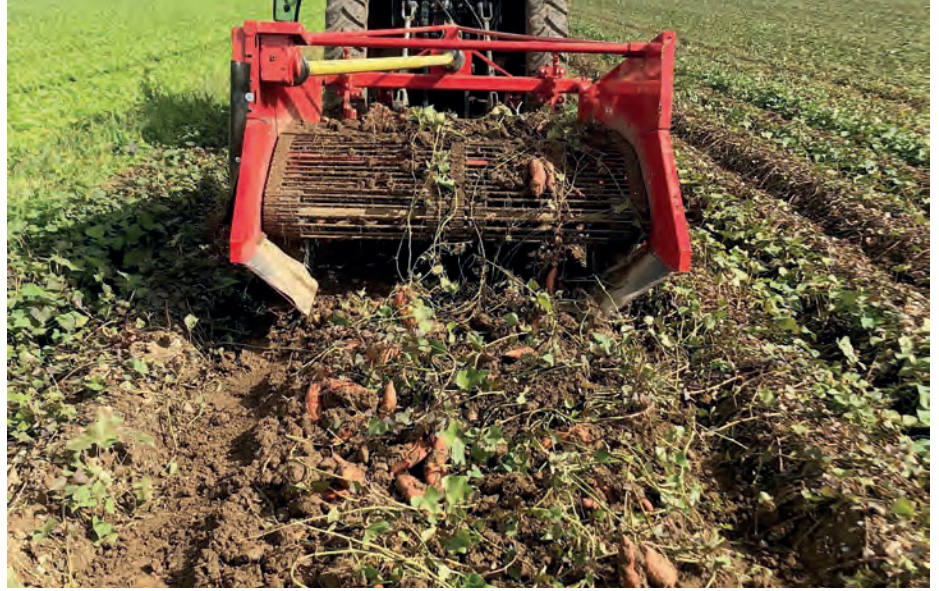
Einsatz des Siebkettenroders bei der Süßkartoffelernte.
